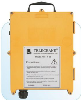
F-23 接收機 電源：交流 AC 48/110/220V或 交流 AC 110/220/380V或 交流 AC 48/220/380V 尺寸：290x230x70公厘 重量：1900公克
